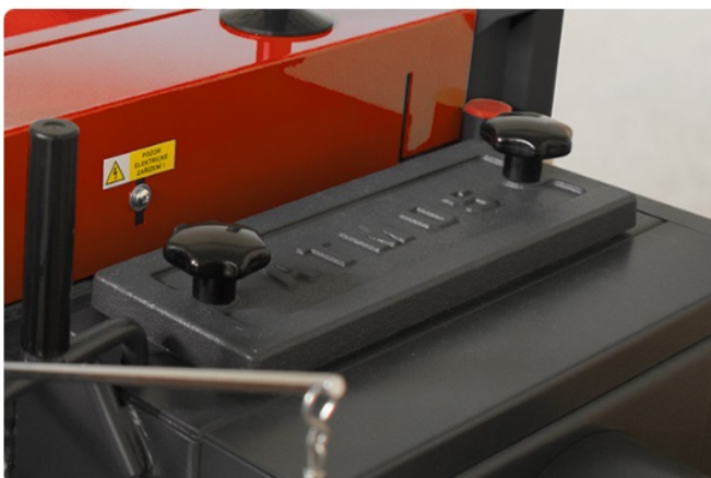
Górna pokrywa do czyszczenia kotła
